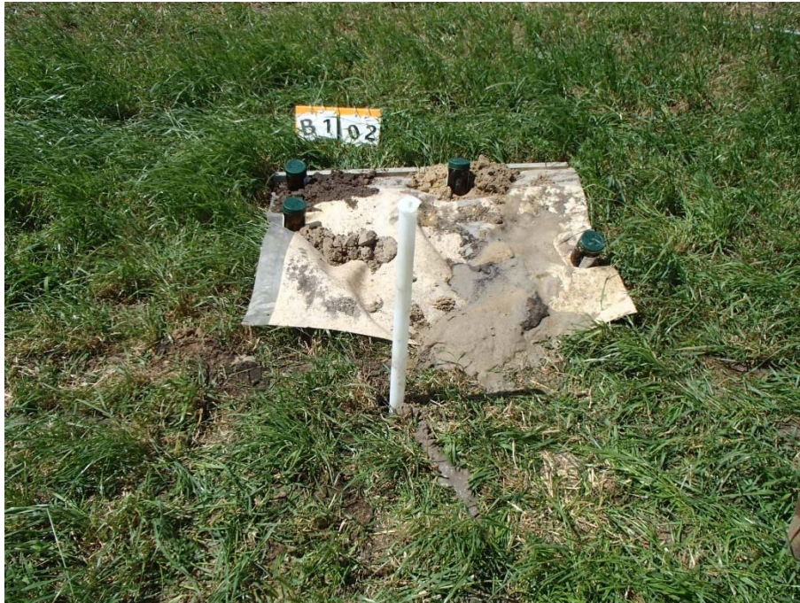
Foto 9. Bodemopbouw ter plaatse van peilbuis 102
