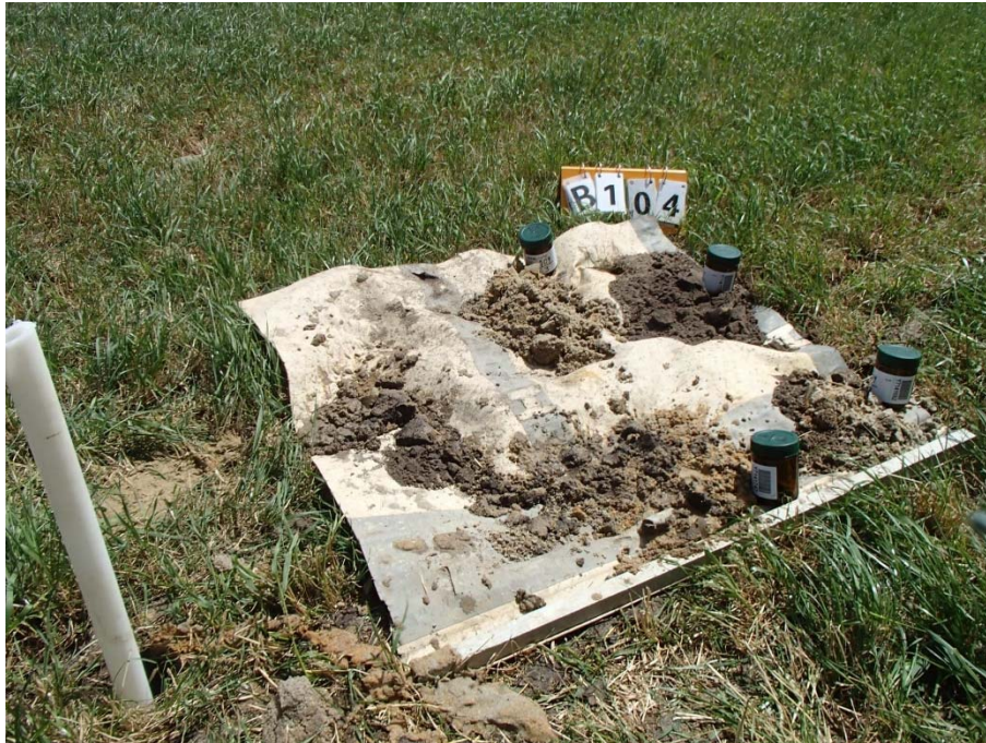
Foto 11. Bodemopbouw ter plaatse van peilbuis 104
