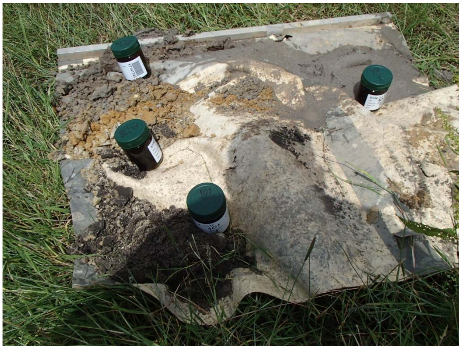
Foto 8. Bodemopbouw ter plaatse van peilbuis 101
